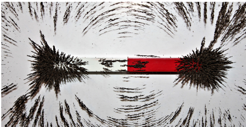
Figur 3.c: Foto af de magnetiske feltlinjer omkring en stangmagnet. (Kilde: Helena Ibsen)
